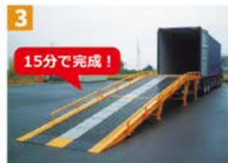
3 架台3を2へセットして完了
