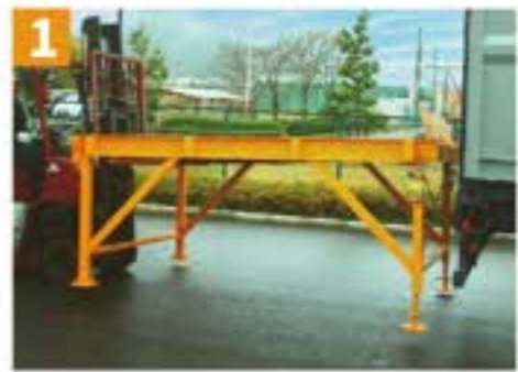
1 架台1をコンテナに接続
